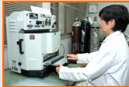
การทดสอบรอยเชื่อมของช่องพลาสติก
